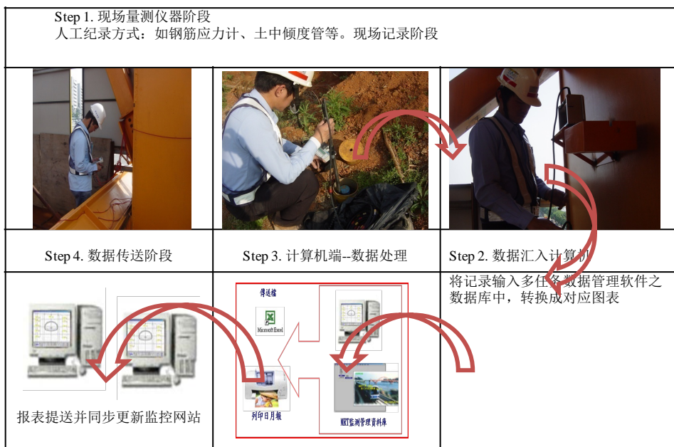
Figure 16. Manual measurement process 图 16. 人工量测流程
