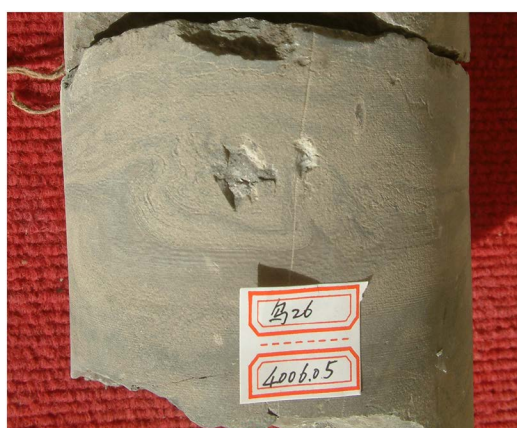
Figure 9. Liquefaction load bag structure formed by vibration compaction (W 26, 4006.05 m, core photograph) 图 9. 震动压实作用形成液化负载囊构造(乌 26 井 4006.05 米, 岩心照片)
