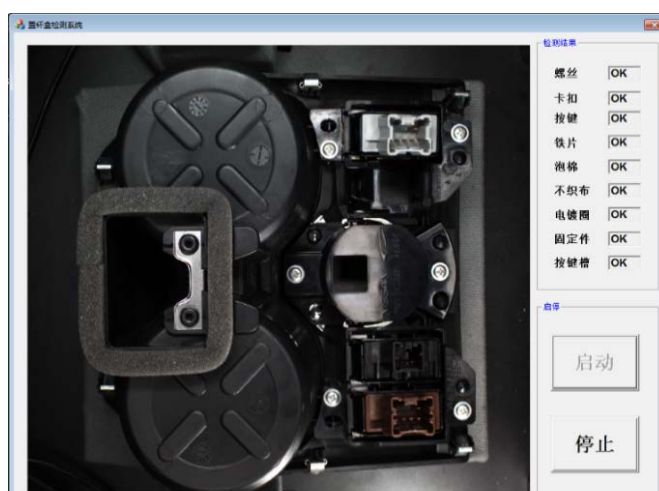
Figure 15. System interface 图 15. 系统界面
