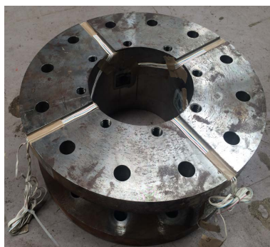
Figure 1. New force transducer 图 1. 新型力传感器
