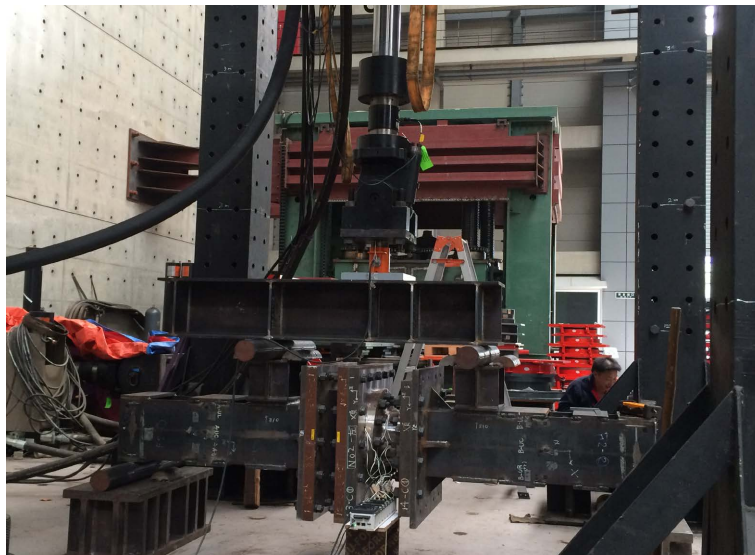
Figure 7. Moment calibration system 图 7. 弯矩标定试验系统
