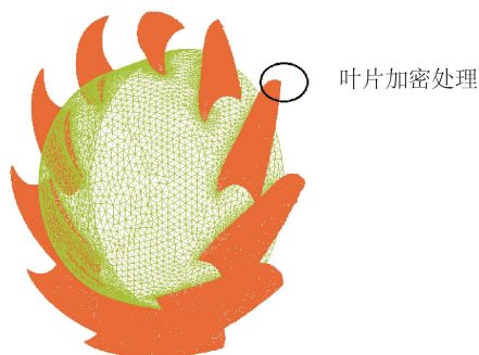
Figure 5. Local mesh encryption of blade 图 5. 叶片局部网格加密
