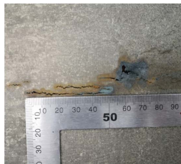
Figure 2. Central crack morphology 图 2. 中心裂纹形貌
