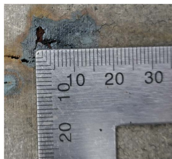
Figure 3. Central shrinkage cavity morphology 图 3. 中心缩孔形貌
