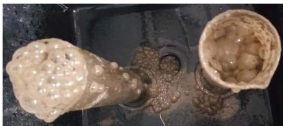
注:投加量为 50 mL、60 mL 时发生污泥膨胀
