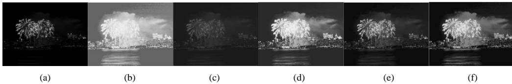
Figure 3. Enhancement results for fireworks: (a) Original; (b) GHE; (c) BPHEME; (d) HMF; (e) CEBGA; (f) CEGMM 图 3. 烟花增强结果: (a) 原图像; (b) GHE; (c) BPHEME; (d) HMF; (e) CEBGA; (f) CEGMM
