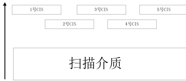
Figure 1. Internal schematic diagram of wide-format scanner 图 1. 宽幅扫描仪内部示意图
