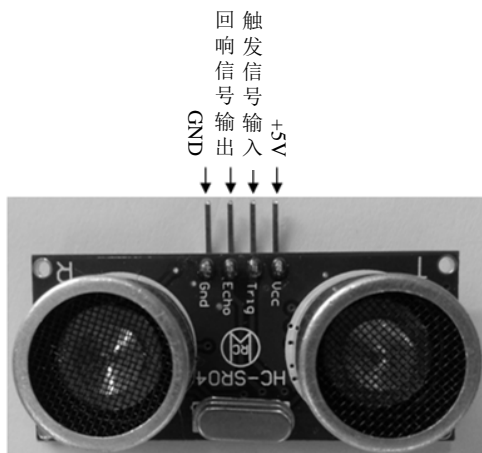
Figure 4. HC-SR04 ultrasonic module 图 4. HC-SR04 超声波模块
