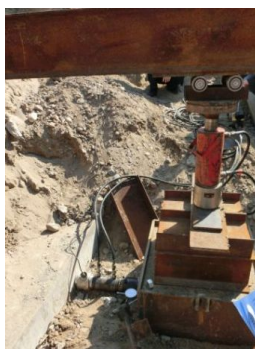
Figure 5. The horizontal pressurization equipment 图 5. 水平加压设备
