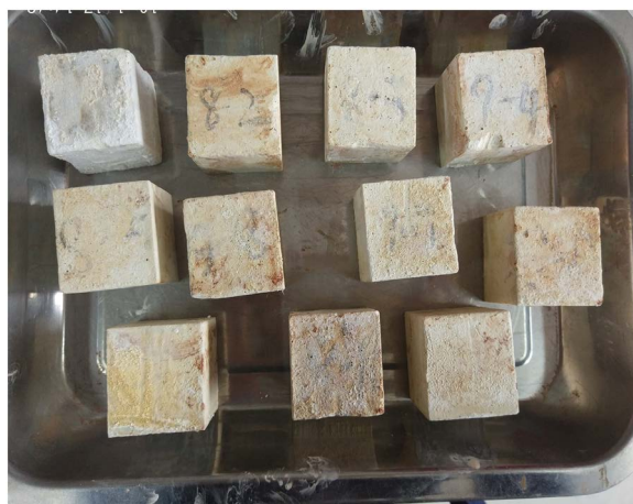
Figure 1. Samples soaked in 10% sulfuric acid solution 图 1. 在浓度为 10% 硫酸溶液浸泡后样品
