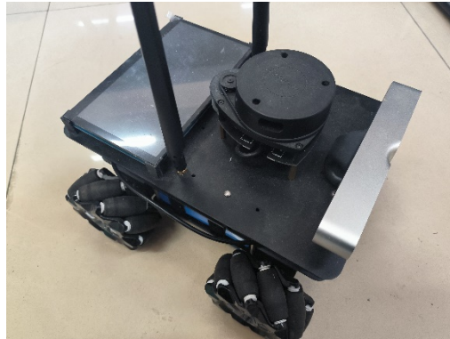
Figure 3. AGV entity 图 3. AGV 实体
