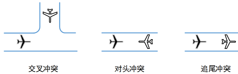
Figure 2. Airport scene conflict diagram 图 2. 场面冲突示意图
