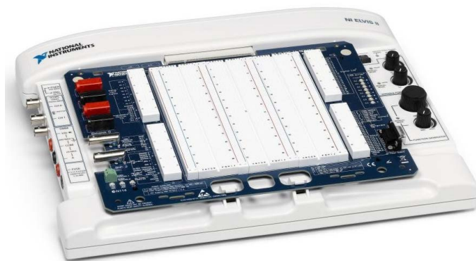
Figure 3. NI ELVIS II virtual instrument platform 图 3. NI ELVIS II 虚拟仪器开发平台
