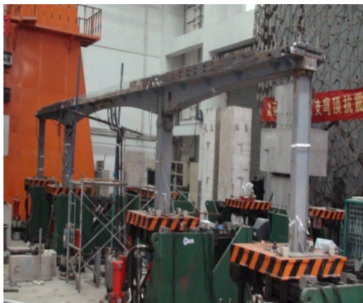
Figure 1. Nine sub-array system of BJUT 图 1. 北京工业大学九子台阵系统
