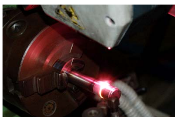
Figure 5. Visible spot technique applied in cylindrical surface 图 5. 可见光斑法在轴类工件表面的应用
