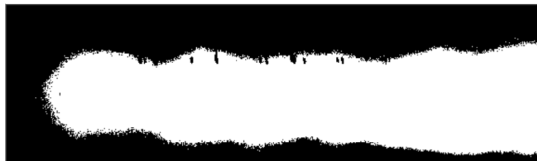
(b) 中值滤波 + Otsu 阈值处理
