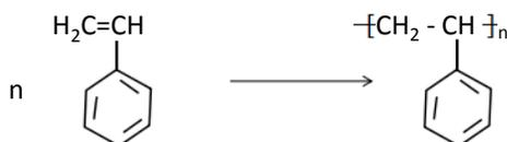
聚苯乙烯乳液制备操作如下,三口烧瓶依次连接温度计、电动搅拌桨、冷凝管,在三口烧瓶内装入 90 ml 的去离子水,在机械搅拌的同时将恒温水浴锅温度升至 70℃。真空泵 10 min 抽真空将空气排净,再向体系内充入氩气 Ar 30 min。以 1#样品为例(表 1),取 0.1 g 共聚单体 HEMA、0.05 g 引发剂 KPS 和 0.05 g 电解质 NaCl 分别溶于 4 ml、3 ml 和 3 ml 去离子水中。完全排净三口烧瓶中的空气后,依次用注射器注入 10 g 单体 St、4 ml HEMA 和 3 ml KPS 溶液,待溶液反应体系由澄清透明变为浑浊后加入 3 ml NaCl 溶液。所有药品加入后,体系在恒温 70℃和充入 Ar 的条件下充分反应 24 h。反应结束将体系自然冷却至室温,得到 PS 微球乳液,过滤离心备用。
