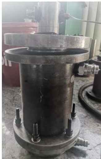
Figure 5. Pressure chamber 图 5. 压力室实物图
