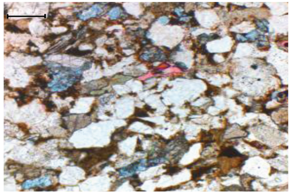
(b) 黏土杂基和铁白云石充填孔隙，黏土矿物吸附重油(里44井, 2260.43m)
