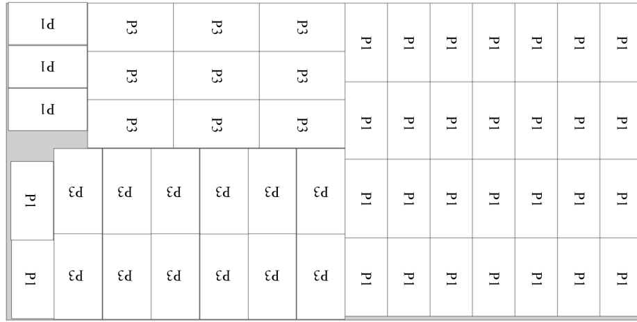
Figure 6. Schematic diagram of wood cutting scheme 2 for product P1 and P3 图 6. 产品 P1 和 P3 的木板切割方案 2 示意图
