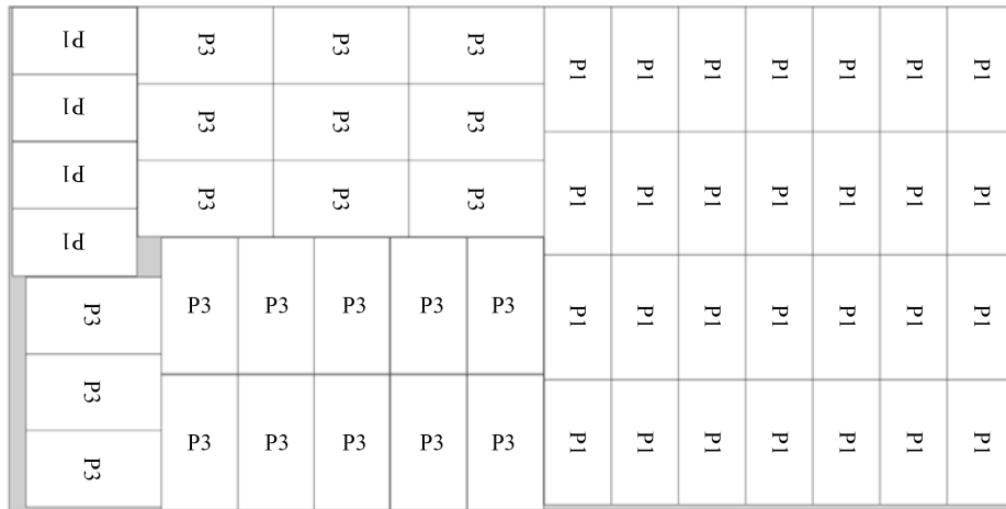
Figure 5. Schematic diagram of wood cutting scheme 1 for product P1 and P3 图 5. 产品 P1 和 P3 的木板切割方案 1 示意图
