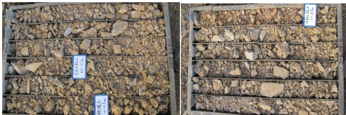
Figure 3. Loose layer characteristics of Lin Chuan landslide 图 3. 林川滑坡松散层特征
