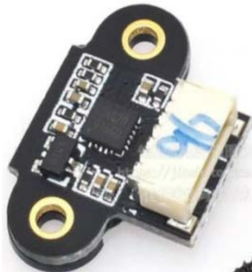
Figure 3. TOF distance sensor 图 3. TOF 距离传感器
