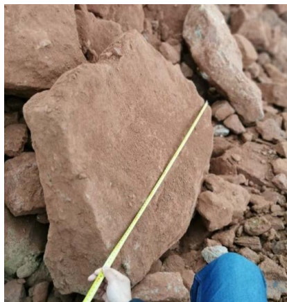
Figure 2. Backfill particle size measurement 图 2. 回填料粒径测量
