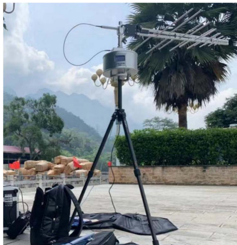
Figure 1. Electromagnetic environment test system 图 1. 电磁环境测试系统
