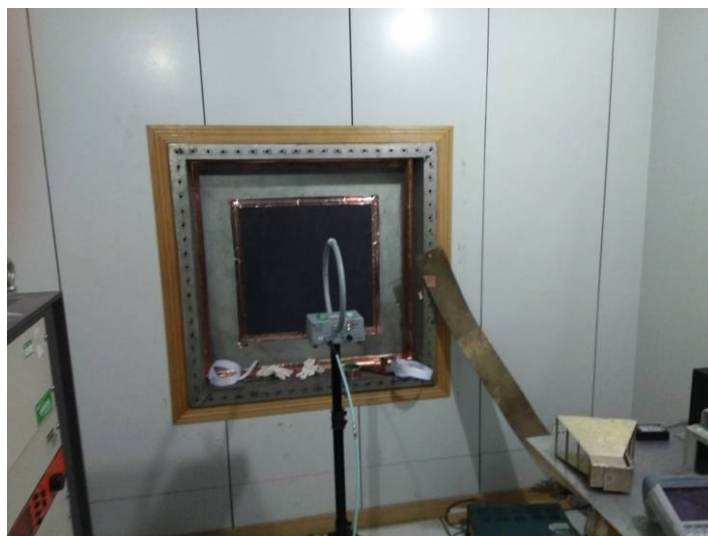
Figure 5. Electromagnetic shielding performance test photos 图 5. 电磁屏蔽性能测试照片
