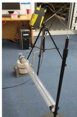
Figure 11. The rig of the pipe vibration 图 11. 管道振动测试实验装置
