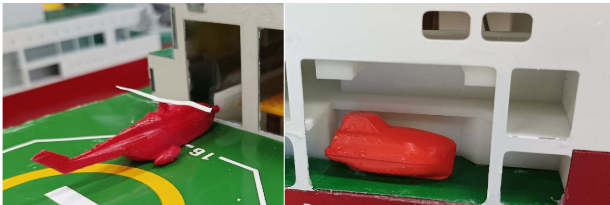
Figure 6. 3D printed parts in ship model making 图 6. 船模制作中的 3D 打印零部件
