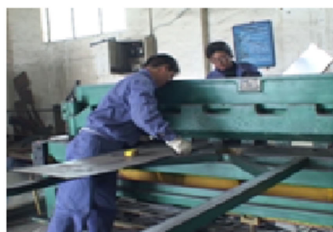
图1.1 用剪床将冷轧钢板裁成要求板条
