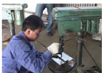
图1.4 用台钻钻孔用于安装转轴
