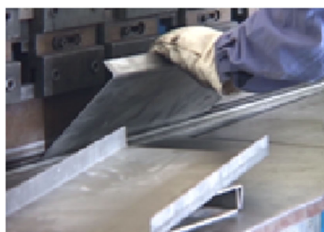
图1.2 用折边机将板条按加工工艺图 纸要求折边
