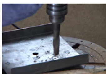
图1.5 用台钻钻孔用 于安装易熔构件
