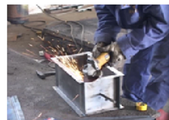
图1.9 用砂轮片磨机打磨焊接毛刺 整理外形
