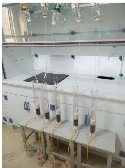
Figure 2. Filter test device diagram 图 2. 淋滤试验装置图
