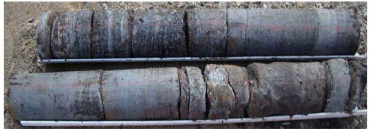
(b) 2 砂组砾、砂、泥交互厚度 16 m，油浸 3.9 m。
