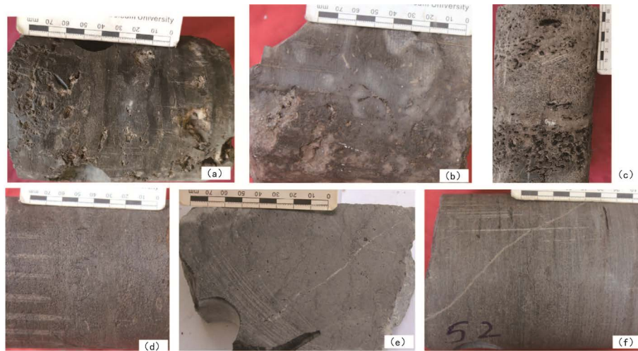
a) 孔洞, 直径 1~15 mm, 被白云石部分充填, 砂屑云岩, 高石 23 井, 第 8 筒 3 块岩心; b) 孔洞, 局部可见裂缝扩溶特征, 被白云石、石英部分充填, 砂屑云岩, 高石 23 井, 第 4 筒 35 块岩心; c) 蜂窝状溶蚀孔洞, 成层状分布, 砂屑云岩, 高石 001-X24 井, 4957.61m, 第 2 筒 44 块岩心; d) 针状溶孔, 孔径 0.2~1 mm, 可见沥青质充填的缝合线, 鲕粒云岩, 高石 23 井, 第 3 筒 38 块岩心; e) 白云石部分充填的针状溶孔, 孔径 0.2~2 mm, 发育一条白云石部分充填的构造缝, 砂屑云岩, 高石 7 井, 第 1 筒 5 块岩心; f) 斜交状构造缝, 白云石全充填, 局部可见针状溶孔, 高石 11 井, 砂屑云岩, 第 1 筒 138 块岩心。
