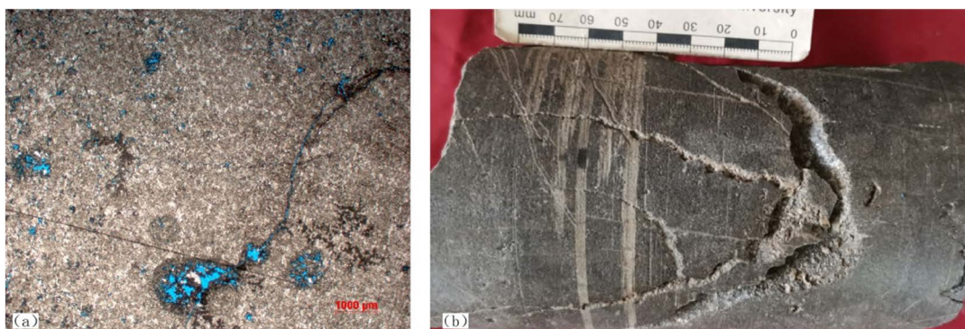
a) 溶蚀作用是的藻砂屑或藻粘结构形成粒内溶孔，构造缝连通部分孔隙，GS23 井，4662.5m，铸体薄片，(-); b) 两期裂缝，被白云石、石英部分充填，并有扩溶特征，围岩可见毫米级溶蚀孔洞，GS001-X24，第 2 筒 18 块岩心。
