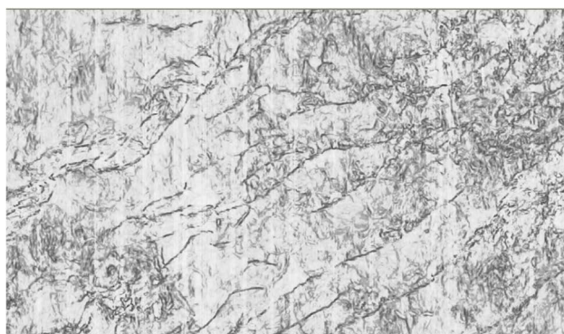
Figure 4. Plane slice of coherence cube 图 4. 相干体平面沿层切片属性
