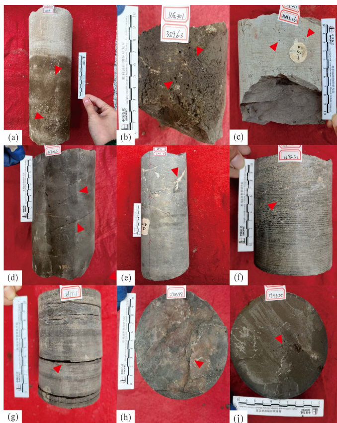
(a) 礁核相, 生物灰岩, 孔缝发育, SG2 井, 2585.80 m; (b) 礁间水道相, 砂屑灰岩, 孔缝较发育, YD301 井, 3596.30 m; (c) 礁缘相, 泥晶灰岩, 孔缝少量发育, S271 井, 2463.26 m; (d) 礁前相, 泥晶灰岩, 发育微裂缝, YD301 井, 3596.30 m; (e) 礁后相, 泥晶灰岩, 微裂缝被方解石充填, S10 井, 2709.30 m; (f) 滩核相, 鲕粒灰岩, 发育微裂缝, S54 井, 2793.52 m; (g) 滩间水道相, 泥晶灰岩, 微裂缝较发育, L14 井, 2955.10 m; (h) 滩缘相, 泥晶灰岩, 孔缝发育较少, XL39 井, 2920.48 m; (i) 灰泥相, 泥晶灰岩, 孔缝基本不发育, XL39 井, 2943.25 m
