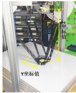
Figure 9. Measuring coordinates of real workspace 图 9. 实际工作空间测量示意图
