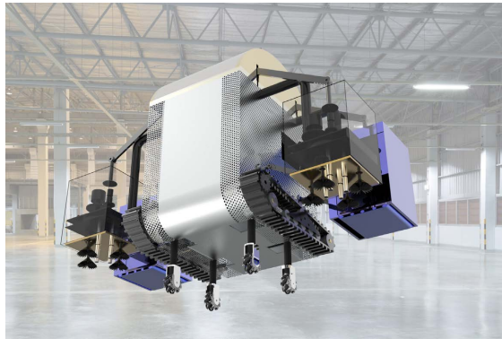
Figure 1. Wheelchair module 图 1. 楼梯清洁机器人总体结构图
