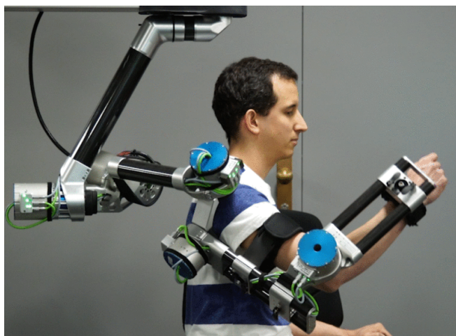
Figure 7. Multifunctional upper limb exoskeleton rehabilitation robot 图 7. 多功能上肢外骨骼康复机器人
