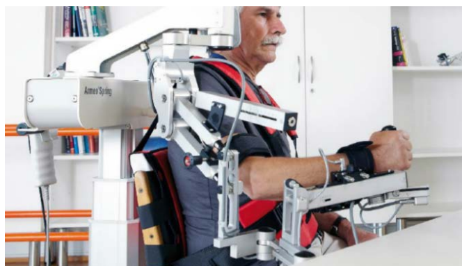
Figure 6. ArmeoSpring upper limb rehabilitation robot 图 6. ArmeoSpring 上肢康复机器人
