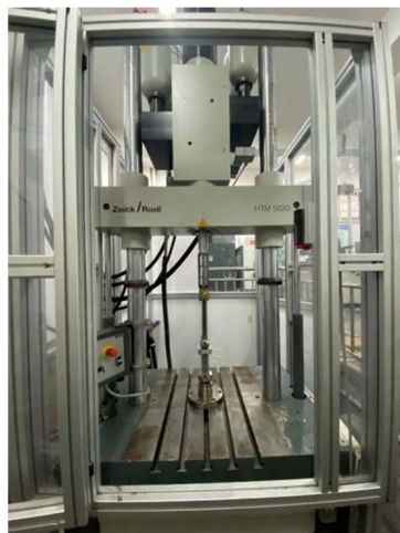
Figure 6. Zwick HTM 5020 high-speed tensile testing machine 图 6. Zwick HTM 5020 高速拉伸试验机
