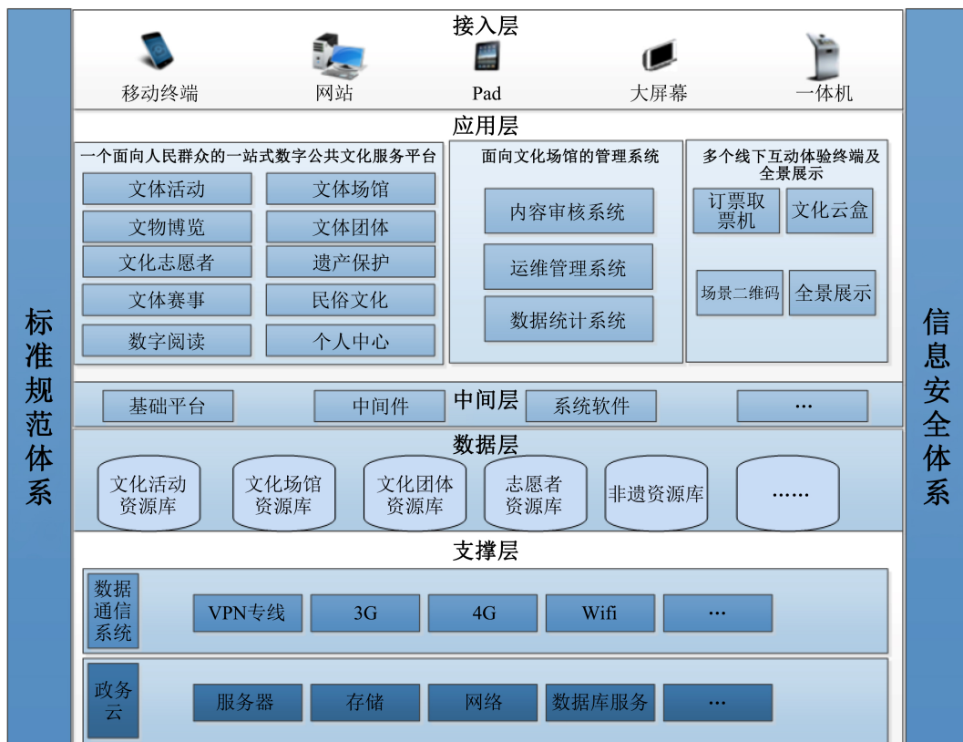
Figure 3. The architecture of Sichuan public cultural cloud service platform 图 3. 四川公共文化云服务平台总体架构
