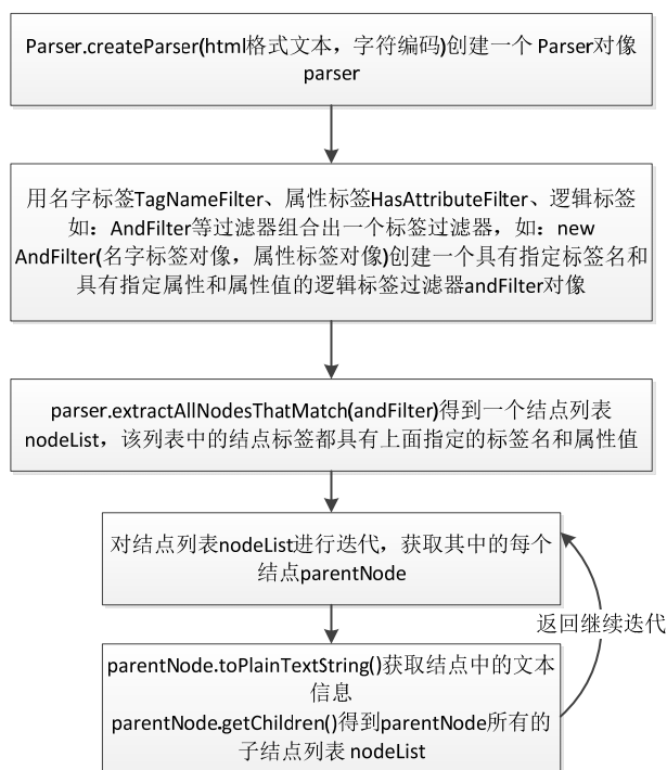
Figure 7. Principle of parsing html 图 7. html 解析原理
