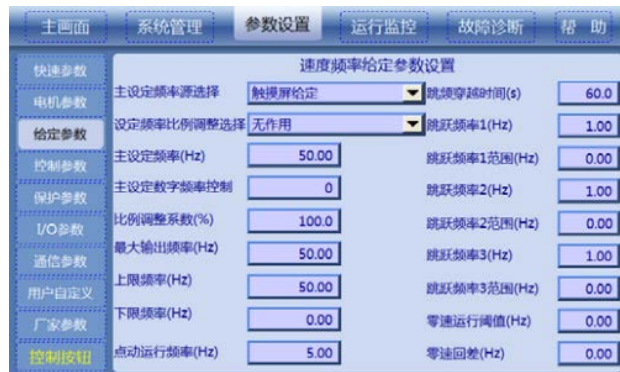
Figure 5. Speed/frequency parameter settings 图 5. 速度频率给定参数设置
