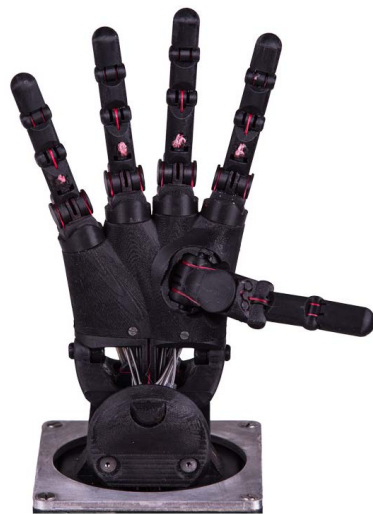
Figure 8. High degree of freedom five-finger manipulator 图 8. 多自由度关节电机驱动型仿人手五指机械手
