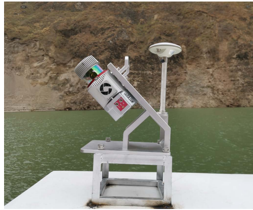
Figure 1. Shipborne LiDAR system 图 1. 船载 LiDAR 系统
