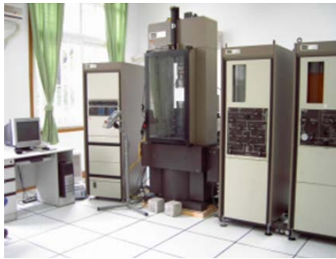
Figure 3. MTS815 rock mechanics test system 图 3. MTS815 岩石力学试验系统
