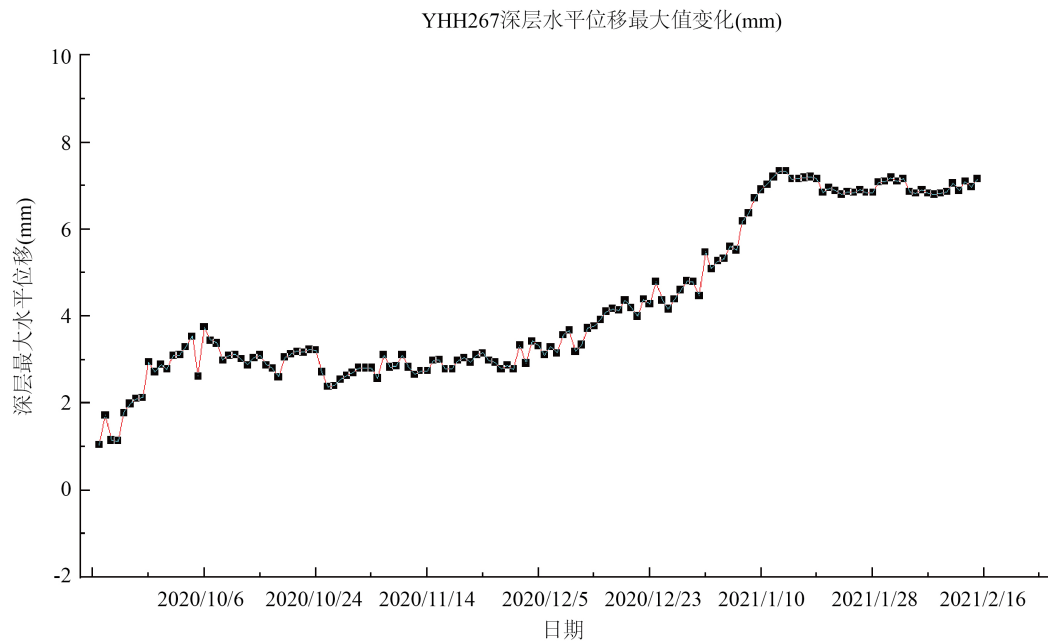
Figure 6. The change of the maximum value of YHH267 pile deep horizontal displacement 图 6. YHH267 桩深层水平位移最大值变化图
