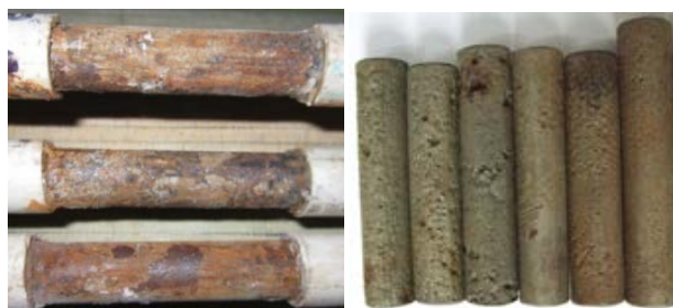
(b) 未酸洗的锈蚀钢筋
