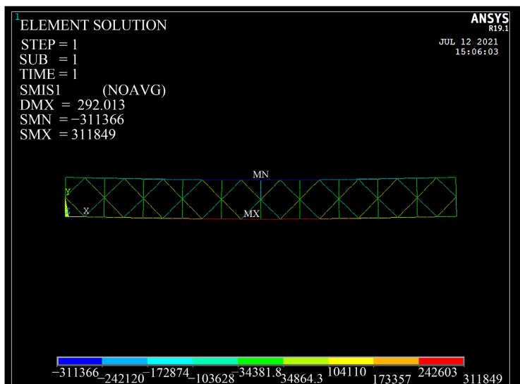
Figure 7. Axial force cloud diagram of 8 transverse Bailey beams 图 7. 横向 8 片贝雷梁轴力云图
