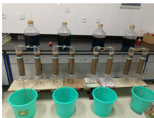
Figure 1. Schematic diagram of infiltration device 图 1. 渗透装置示意图
