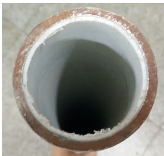
Figure 7. PVC lined steel pipe 图 7. 内衬 PVC 钢管
